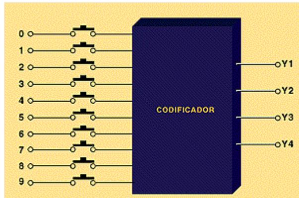
Diagrama de bloques de un codificador de 10 entradas y 4 salidas
